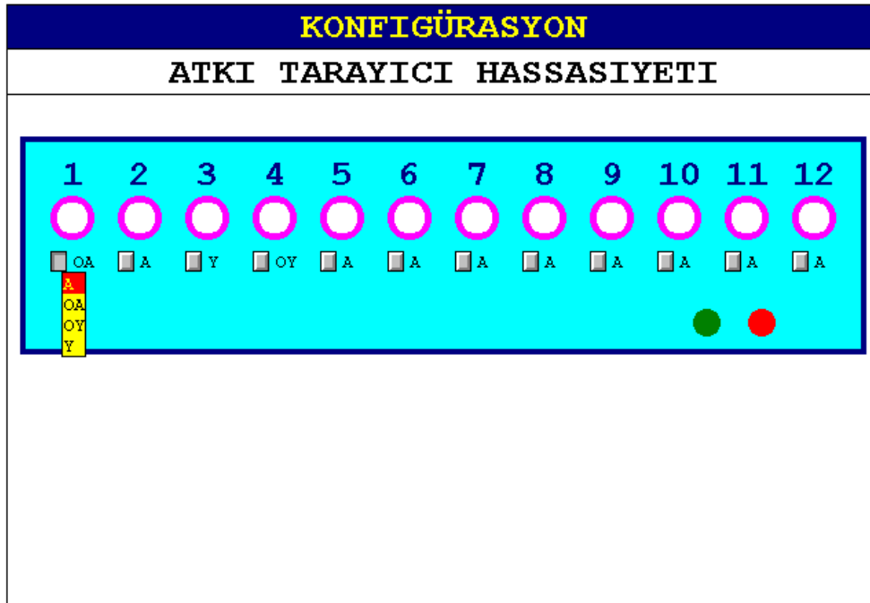
Resim 01.05.03 - 12 renkli TE-400L ufak kafası için hassasiyet belirlenmesi
