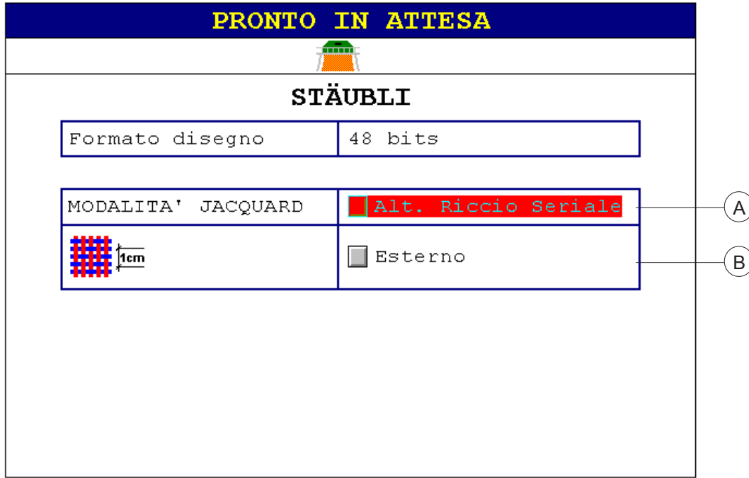
Resim 01.18.36 - Seri ilmek yüksekliği yönteminde Jakarlı tezgah
