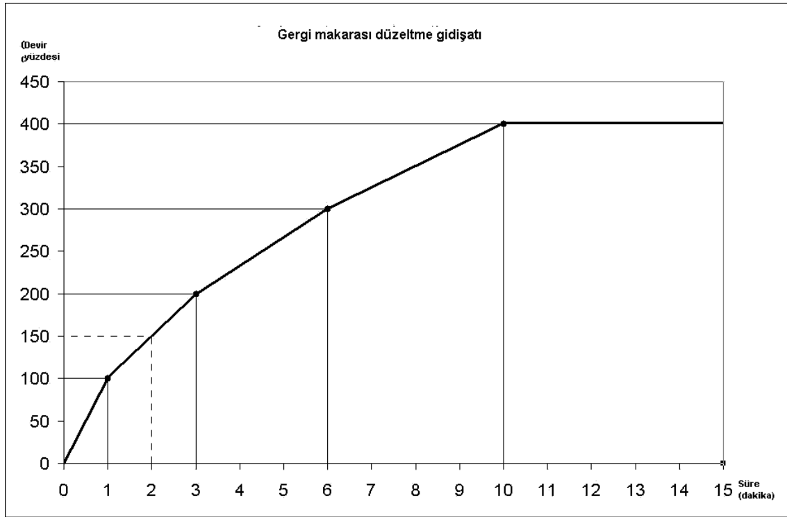
Resim 01.06.04 - Ön start aşaması esnasında düzeltme gidişatı
