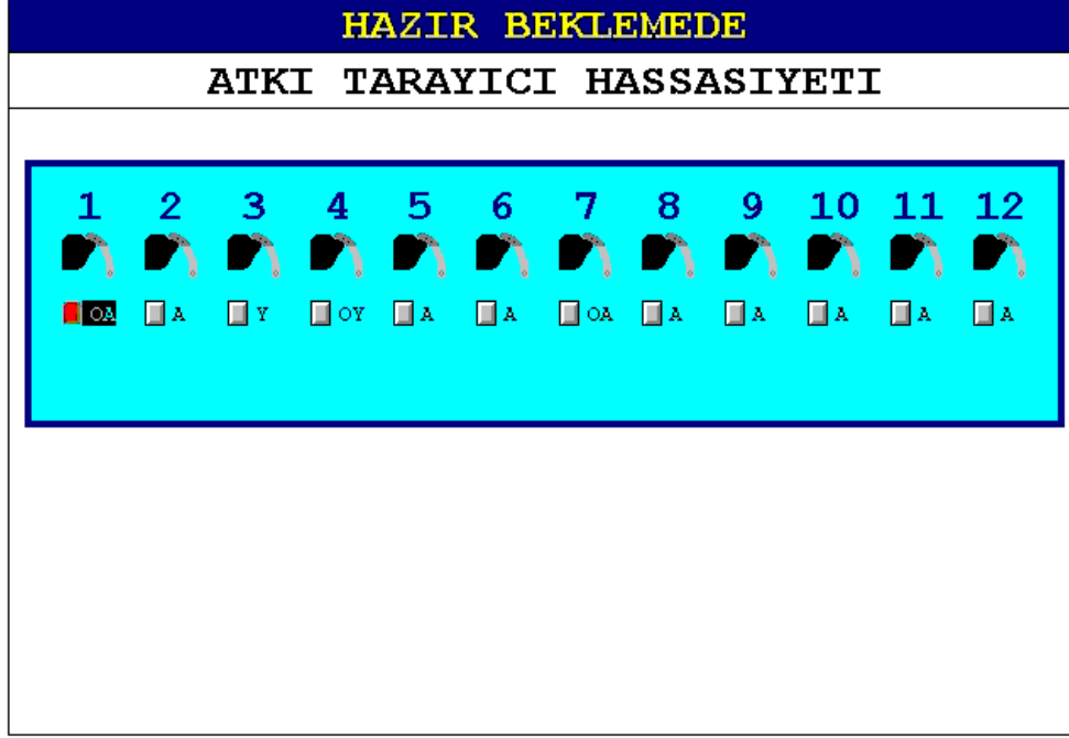
Resim 01.05.04 - TE-ELTEX ufak kafası için hassasiyet belirlenmesi
